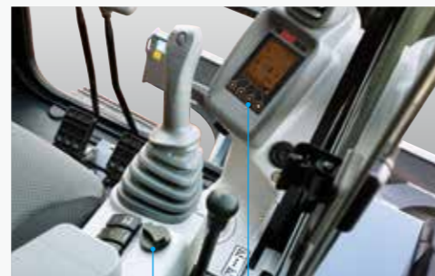
发动机控制杆 ECO/PWR 模式切换开关
